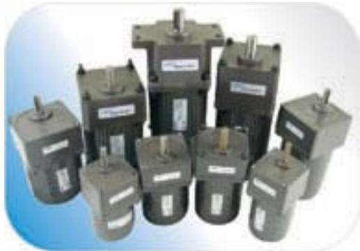
本交流减速电机是目前国际上较先进的低转速电机。采用交流单相电容运转电机，配上一种合适的齿轮减速器，达到某种需要的输出。适合于在低转速传动装置中作驱动元件，能起到简化机械结构和降低能耗的作用。按其功能分有YY型感应电动机和YN型可逆电动机两种，每种还可以增加无级变速的速度控制功能。部分电机还可配带微型电磁制动器。
